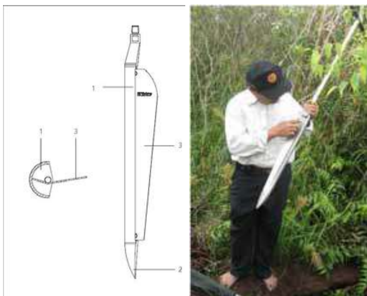
Gambar 4. Skema bagian sampler (bagian utama) bor gambut model Eijkelkamp yang terbuat dari besi stainless. Bagian utama bor ini terdiri atas (1) setengah silinder yang dilengkapi sayap penutup, (2) kerucut yang masif pada bagian bawah, dan (3) dan sayap penutup. Foto kanan adalah close-up sampler dengan sayap penutup menghadap ke arah kamera. Bagian cekung di bagian luar adalah posisi bor siap digunakan.
