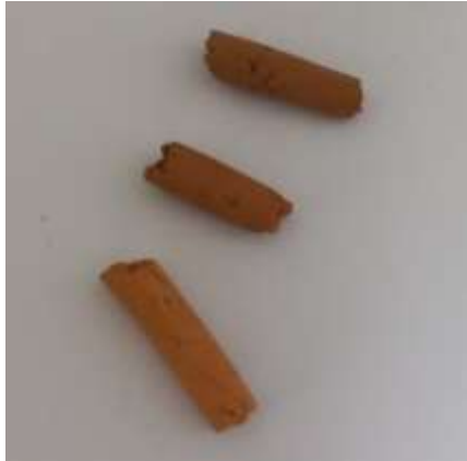
Gambar 3. Gulungan atau benang tanah setebal 3,2 mm pada prosedur menentukan batas plastis tanah.
