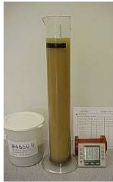
Gambar 3. Hidrometer di dalam silinder berisi suspensi tanah
