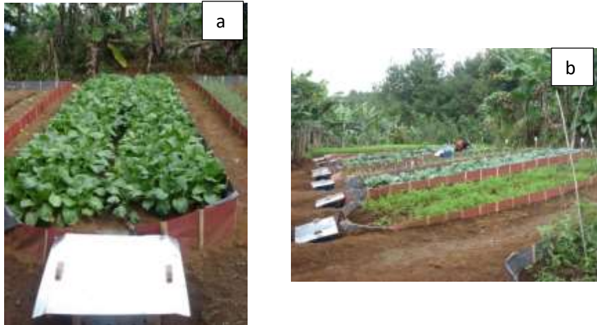
Gambar 4. (a) Petak erosi dari depan, (b) Petak erosi dari samping (Sumber foto: Rahmah)
