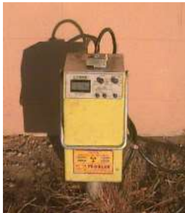
Gambar 1. Neutron probe dengan kabel akses
