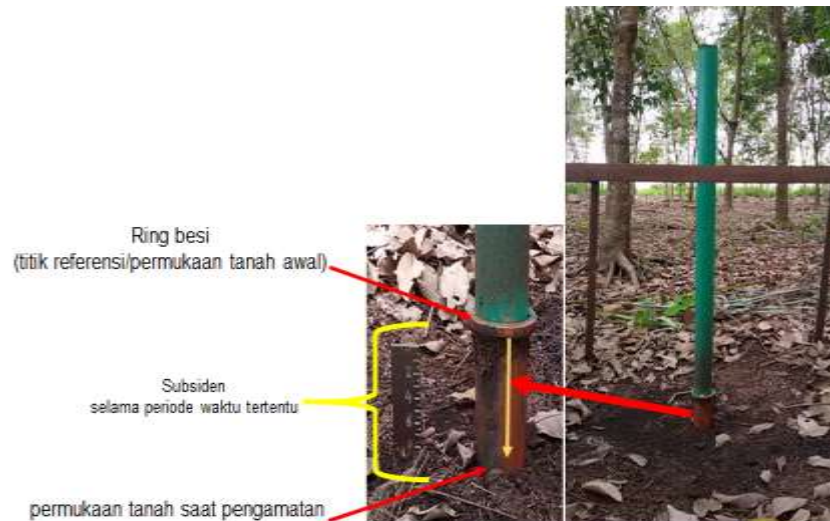
Gambar 5. Teknik pengukuran subsiden dari stik (pipa besi) yang telah diinstal pada lahan gambut
