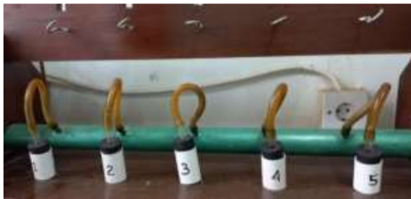
Gambar 3. Selang air yang telah tersambung dengan tabung perkolasi
