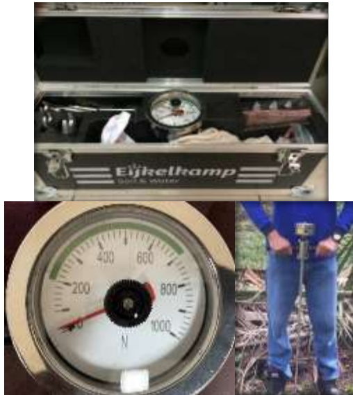
Gambar 4. Penetrometer tangan Eijkelkamp dan pengukuran
