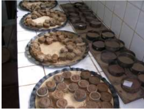
Gambar 2. Persiapan contoh tanah untuk penetapan pF
