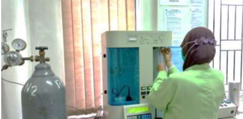
Gambar 4. Memasukkan filler rod ke dalam sample cell
