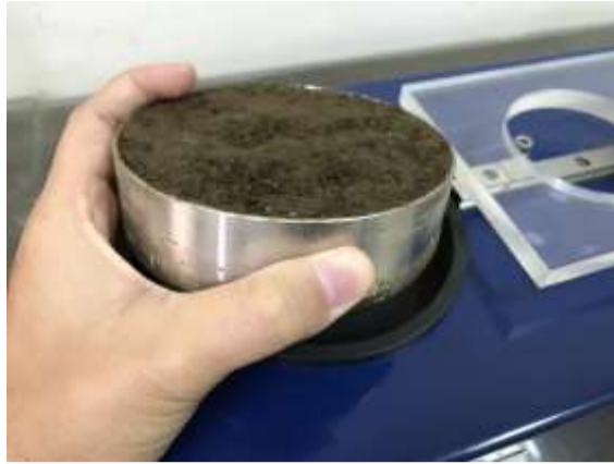
Gambar 8. Peletakan sampel ring tanah ke dalam soil container
