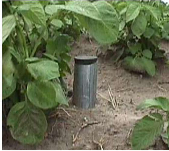
Gambar 4. Tabung akses dari aluminium dengan penutup dari karet
