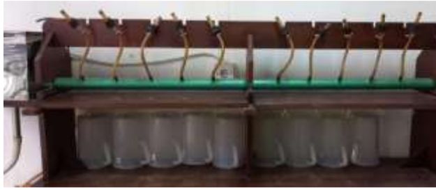
Gambar 1. Instalasi alat pengukur perkolasi di laboratorium
