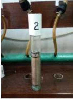
Gambar 2. Susunan lapisan di dalam tabung perkolasi mulai dari lapisan atas sampai lapisan bawah secara berurutan yaitu: wool glass, pasir kasar, sampel tanah, pasir kasar.
