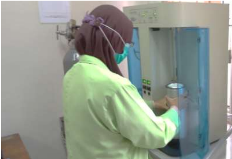
Gambar 3. Peletakan kontainer pendingin dengan gas nitrogen cair ke dalam instrument alat Nova 3200e.
