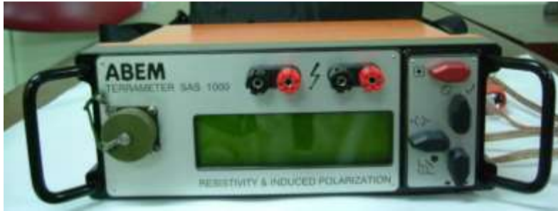
Gambar 3. Prototipe terrameter tipe ABEM terrameter SAS 1000
