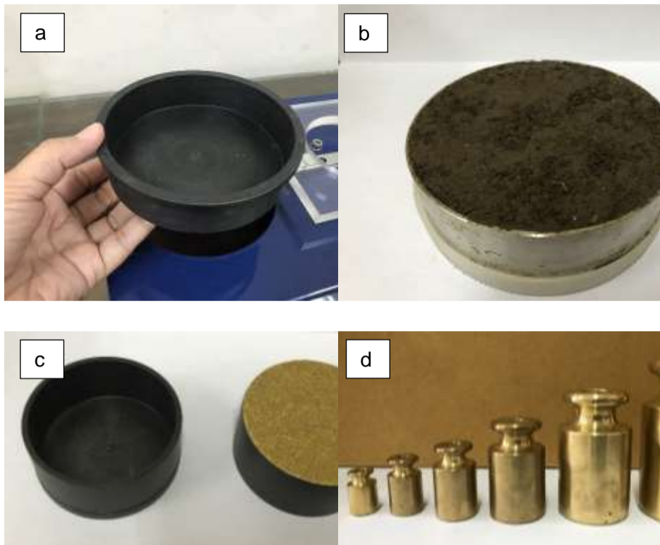
Gambar 7. Peralatan untuk mengukur daya geser tanah: (a) Kontainer sampel tanah, (b) Sampel tanah dalam ring, (c) Shear container , (d) Pemberat timbangan
