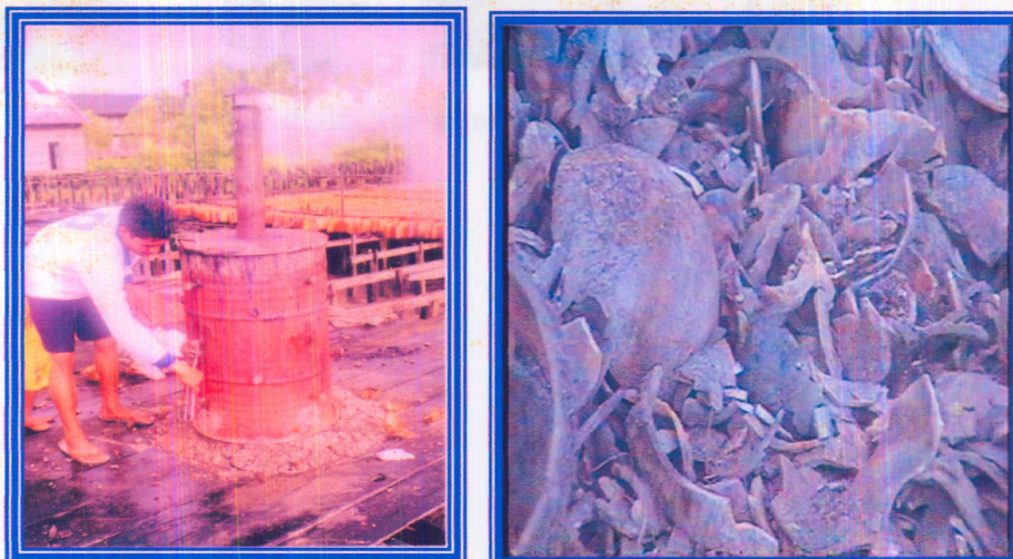
Gambar 18. Alat pengolahan arang tempurung dan hasil arang
