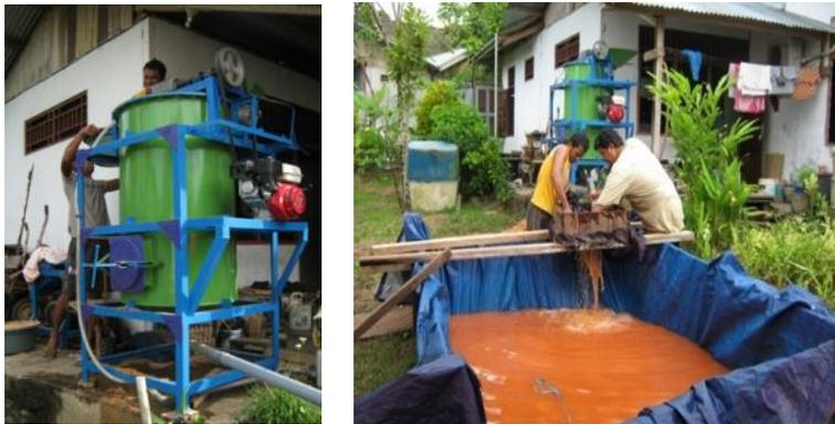
Gambar 1. Konstruksi mesin ekstraksi pati sagu tipe stirrer rotary blades
