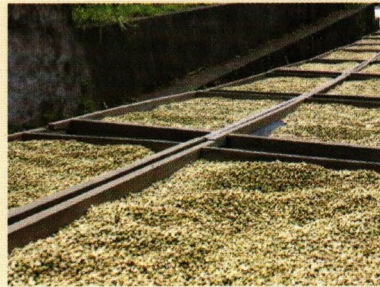
Gambar 13. Contoh rak dan penjemuran biji kopi pada pengolahan basah
