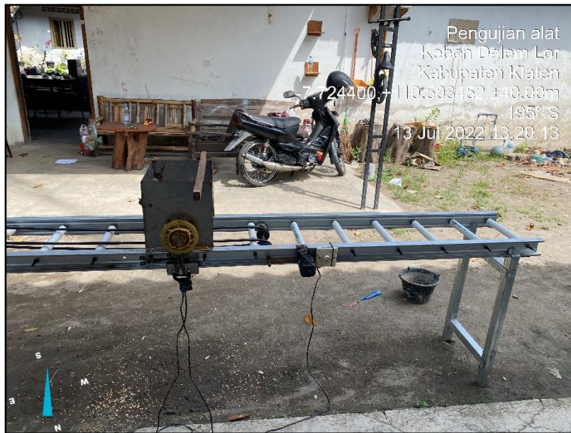
Gambar 4.11. Motor penggerak pada automatic seeding machine
