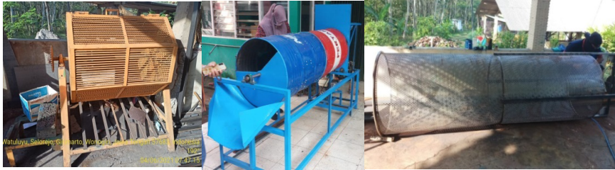
Gambar 12. Peralatan pencucian umbi porang segar.
