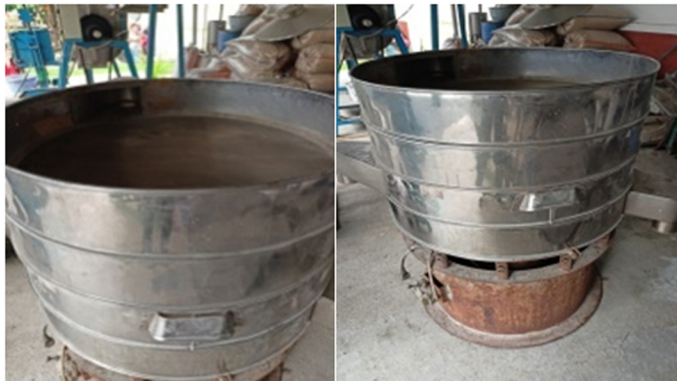
Gambar 16. Mesin pengayakan tepung porang.
