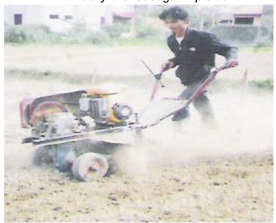
Gambar 4. Pengujian traktor tangan dengan rotary tiller sebagai implement
