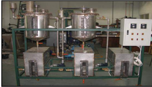
Gambar 93. Alat pengolahan Cocodiesel skala kecil-menengah.
