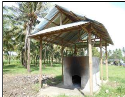
Gambar 80. Alat pengering kopra tradisional dan kopra putih.
