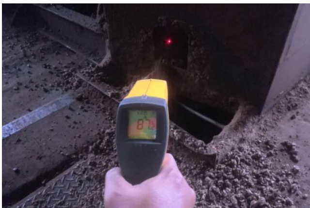
Gambar 1 Alat ukur suhu dan monitoring suhu selama produksi PKE
