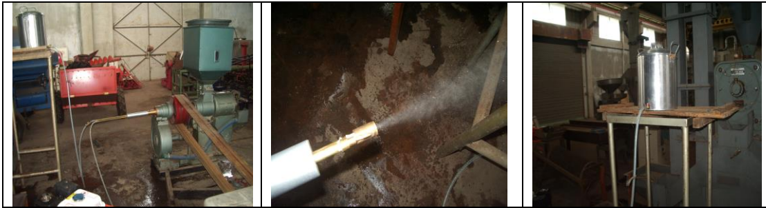
Gambar 1. Mesin pemoles beras berpengabut hasil modifikasi BBP Mektan
