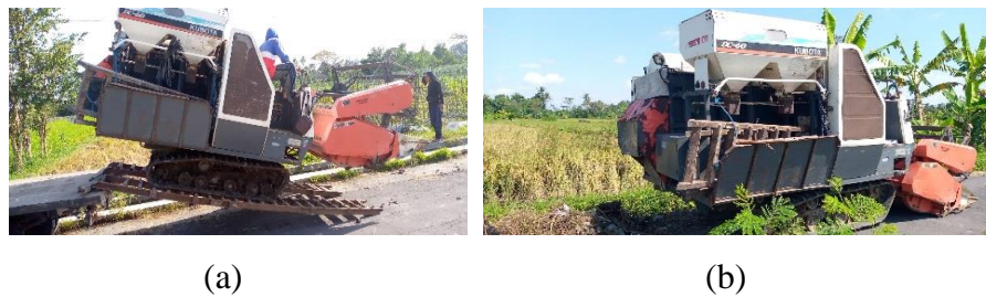
Gambar 17. Combine harvester diturunkan dari unit transportasi sedekat mungkin dengan lahan yang ingin dipanen, (a) Menurunkan combine harvester dekat dengan lahan, dan (b) Posisi combine harvester dekat dengan lahan
