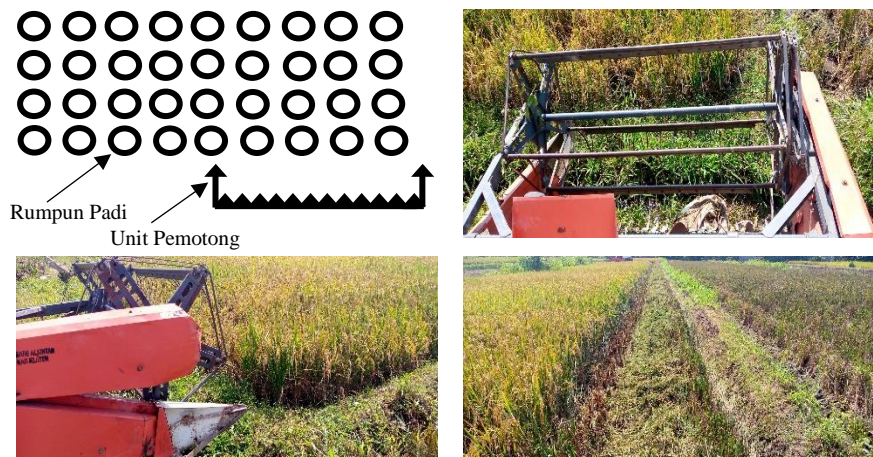
Gambar 21. Cara pemotongan padi
