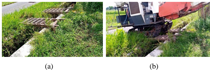
Gambar 18. (a) Tangga jalan untuk melawati parit dengan ukuran tangga 2000 mm x 500 mm, dan (b) combine harvester melawati parit
