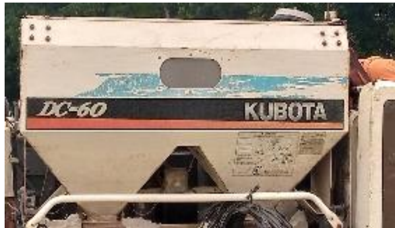
Gambar 10. Bentuk bak penampung ( hopper ) combine harvester Kubota DC-60
