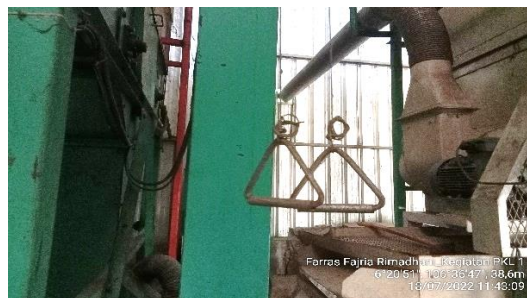
Gambar 16. Tuas pembuka dan penutup pintu pipa
