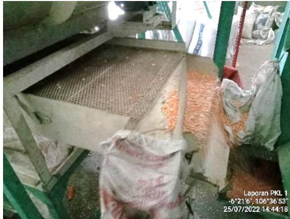
Gambar 18. Benda asing dan biji jagung yang tidak terangkut
