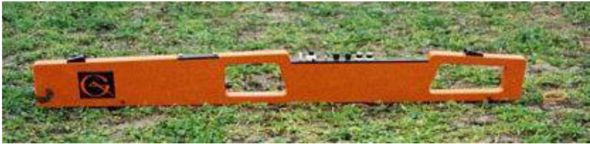
Gambar 7. Instrumen pengukur salinitas tanah di lapang EM38
