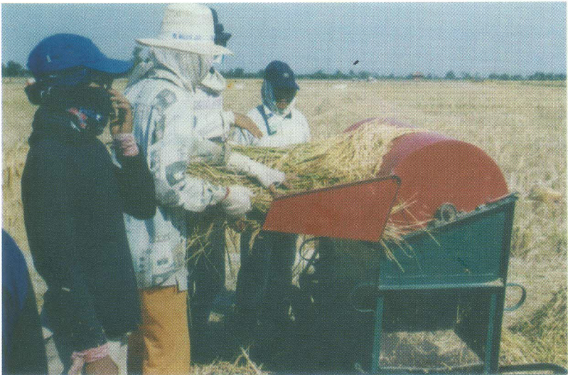
Perontokan gabah dengan alat/mesin perontok mempercepat proses perontokan, menekan tingkat kehilangan hasil, dan meningkatkan mutu beras.
