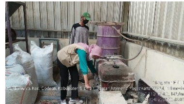
Percobaan pengengkolan pada engine mesin pengering
