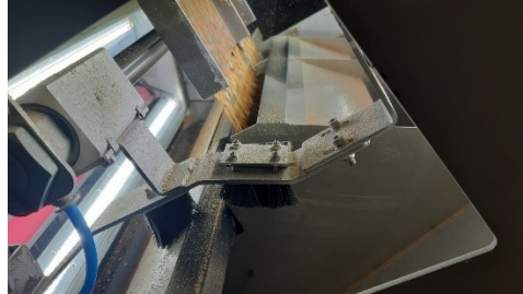
Gambar 43. Penyortiran warna beras menggunakan mesin color sorter
