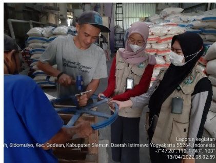
Kegiatan perbaikan Pulley dan As pada Elevator mesin RMU.
