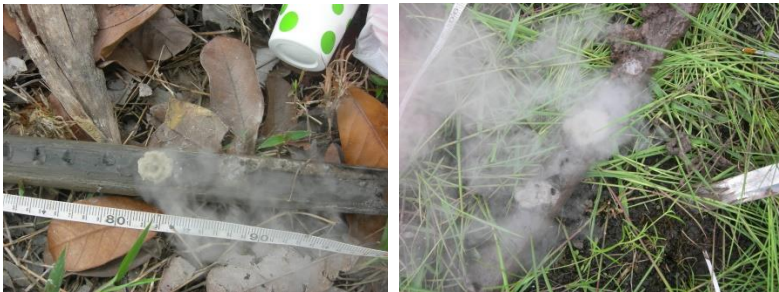
Gambar 72. Rapid test senyawa pirit (bahan sulfidik) menggunakan \text{H}_2\text{O}_2 (Foto: Y. Lestari).
