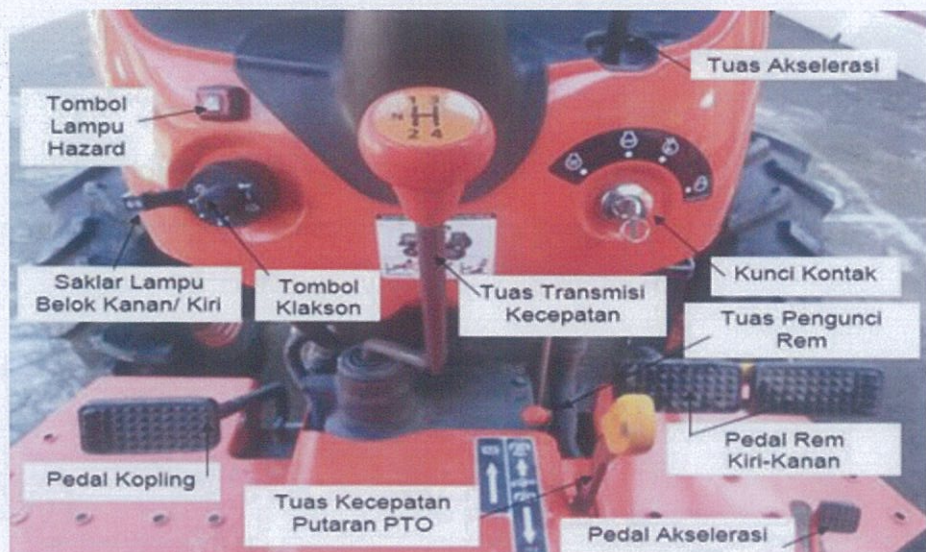
Gambar 75. Indikator dan Saklar pada Dashboard ( http://web.ipb.ac.id/ , April 2016)
