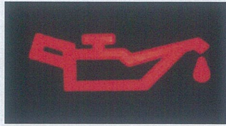
Gambar 82. Indikator Sirkulasi Pelumas
