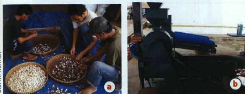
Gambar 35. Pemisahan kernel kemiri sunan dari biji secara manual (a) dan menggunakan mesin decorticator (b)
