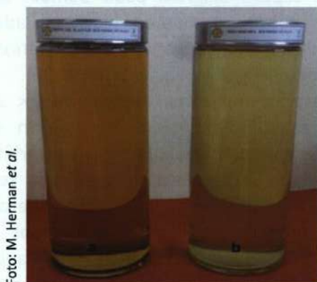
Gambar 37. Minyak kasar (a) dan biodiesel (b) kemiri sunan
