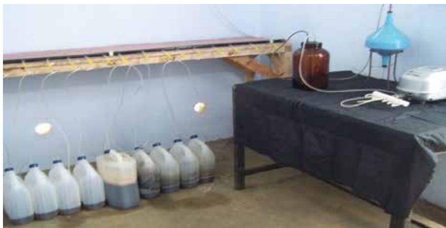
Gambar 1. Biofermentor sederhana yang digunakan untuk fermentasi biopestisida organik cair ( Simple biofermentor was used for biopesticide fermentation )
