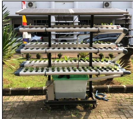
Gambar 7. Rangkaian kit hidroponik NFT berbasis panel surya
