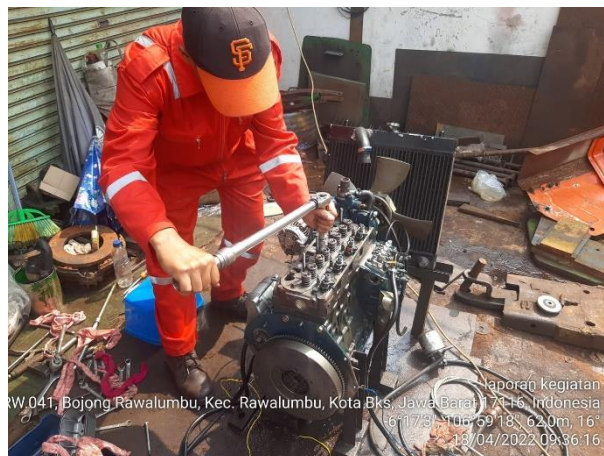
Gambar 4. 4. Membuka cylinder head (sumber : dokumentasi mandiri)
