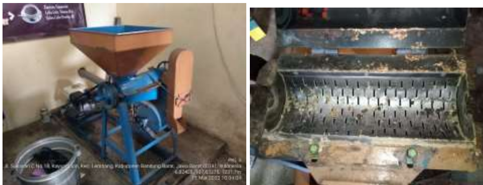
Gambar 15. Mesin huller sebelum pembersihan dan pembongkaran
