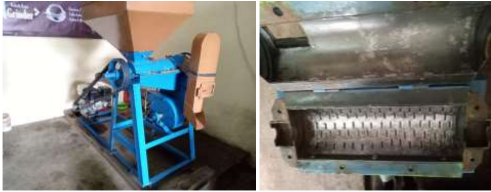
Gambar 16. Mesin huller setelah pembersihan dan pembongkaran
