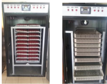
Gambar 6. Inkubator dan penetas otomatis bertenaga listrik (Koleksi S Iskandar)
