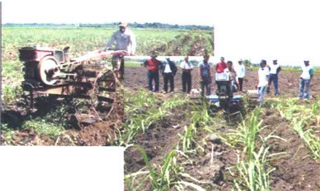
Gambar 1. Pengolahan tanah dan penyiangan menggunakan traktor tangan
