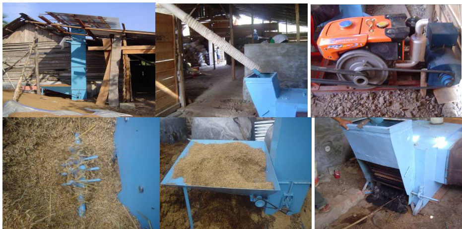
Gambar 4. Sistem pengumpanan sekam dengan suatu konveyor
