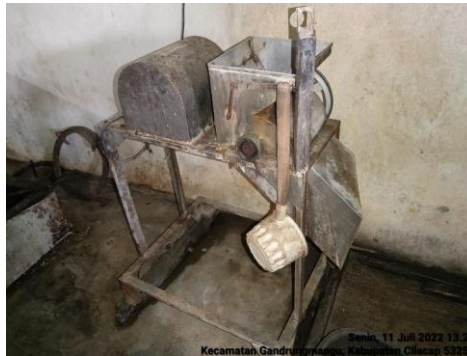
Gambar 11. Mesin pemecah dan pengupas kedelai
