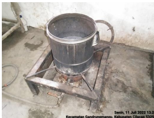
Gambar 10. Dandang dan tungku perebusan dan pencucian kedelai
