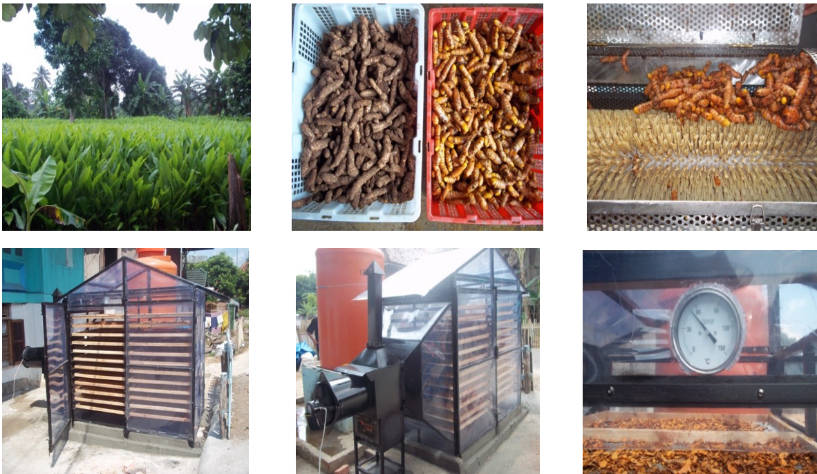
Gb.17. Penggunaan mesin cuci rimpang dan aplikasi mesin pengering untuk menjaga kualitas
