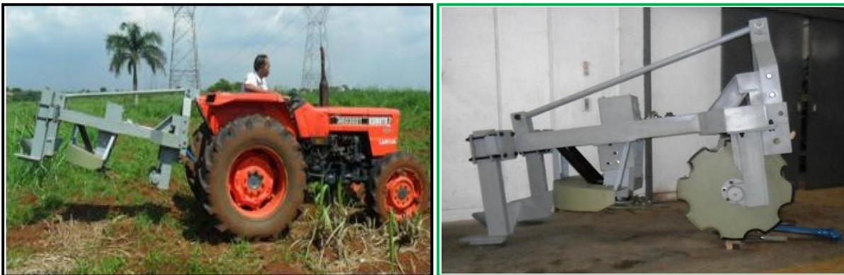
Gb.7. (a) Alat pengepras tebu saat dioperasikan dan (b) Prototipe alat kepras tebu ratoon/ "pedot oyot"
