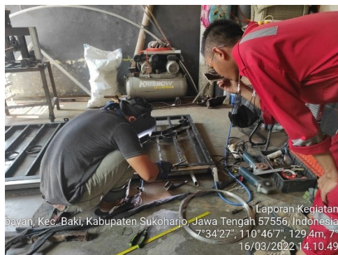
Gambar 4. 3. Proses pengelasan menggunakan elektroda e308 16 (dokumen pribadi)
