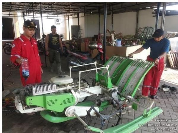
Gambar 7. Tindakan perbaikan selang bahan bakar mesin *rice transplanter*
