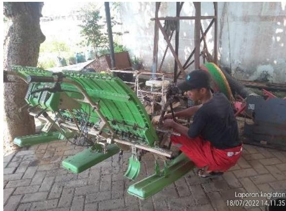
Gambar 9. Tindakan perawatan pelumasan *grease* pada *gear box* transmisi
