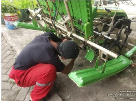
Gambar 8. Tindakan perbaikan per kopling penanam
