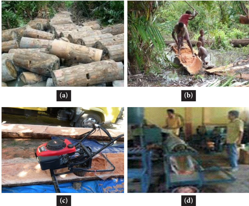
Gambar 12. (a) gelondongan sago siap dibawa ke pabrik pengolahan, (b) penghancuran empulur sago secara tradisional (nokok/tokok), (c) alat penghancur empulur mekanis (Drs. Made, Papua), dan (d) alat pengolahan sago terpadu (Balitka-Manado).
