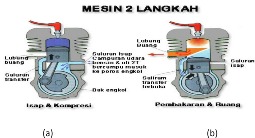
Gambar 4. Prinsip Kerja Motor Dua Langkah
