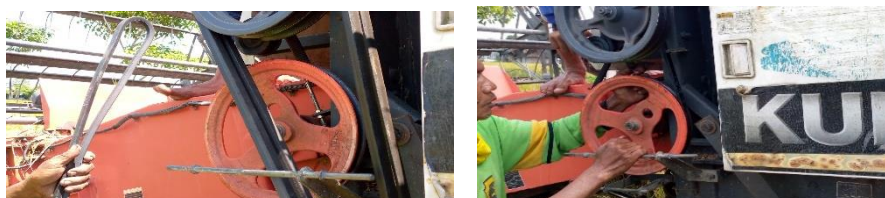
Gambar 4. 13 Perawatan mengganti sabuk v-belt
