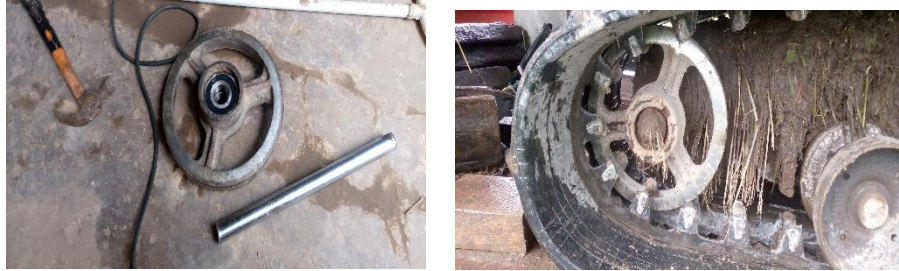
Gambar 4. 16 Memperbaiki roller tension dengan cara mengelas
