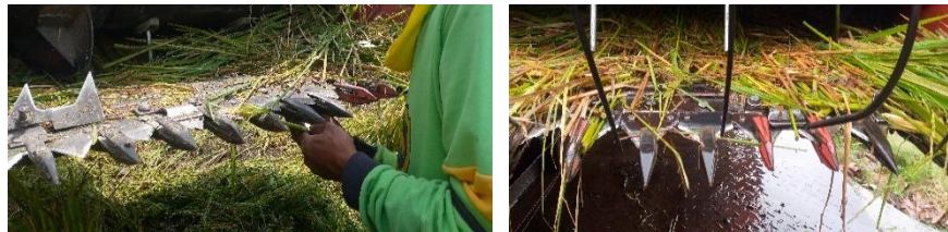
Gambar 4. 12 Perawatan mengencangkan baut pisau pemotong
