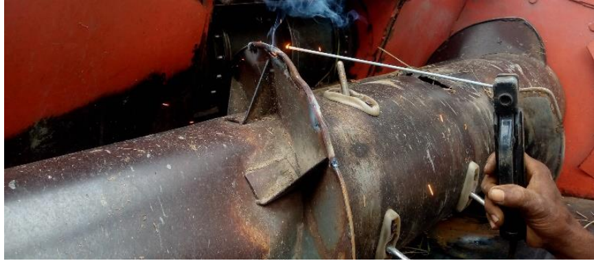
Gambar 4. 20 Mengelas ulir auger drum
