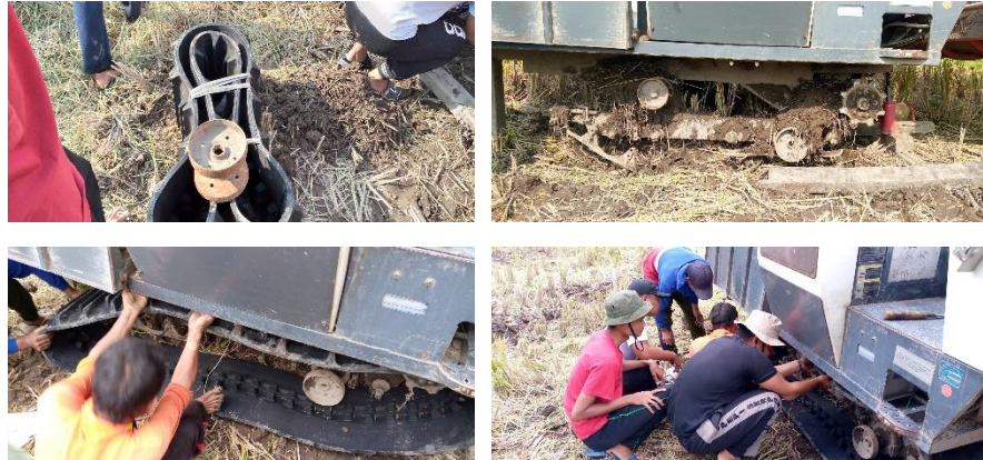
Gambar 4. 14 Perawatan mengganti rubber track
