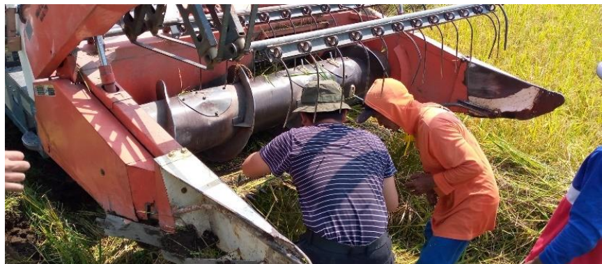
Gambar 4. 10 Perawatan membersihkan pisau pemotong
