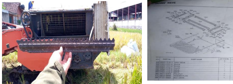
Gambar 4. 11 Mengganti plat upper sieve
