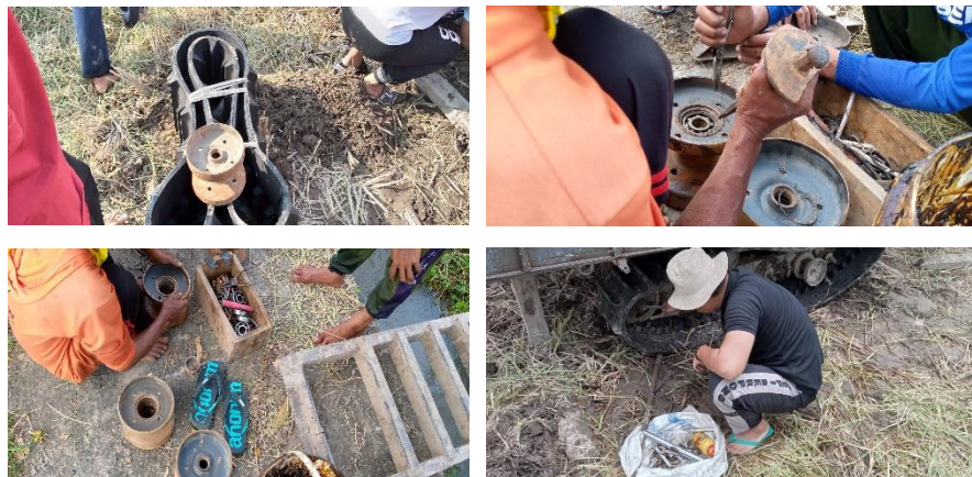
Gambar 4. 15 Perawatan mengganti roller track
