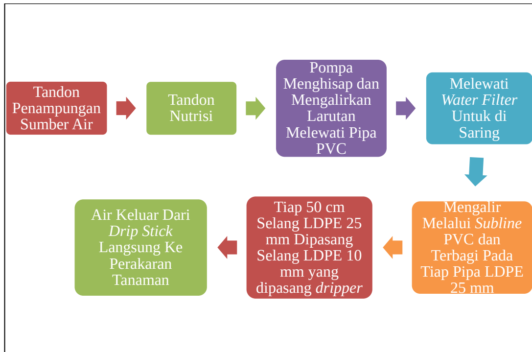
Gambar 7. Diagram Alur Cara Kerja Pengairan Sistem Irigasi Tetes
