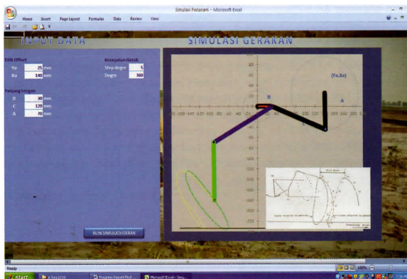
Gambar 4.b. Simulasi empat batang hubung untuk gerak lokus
