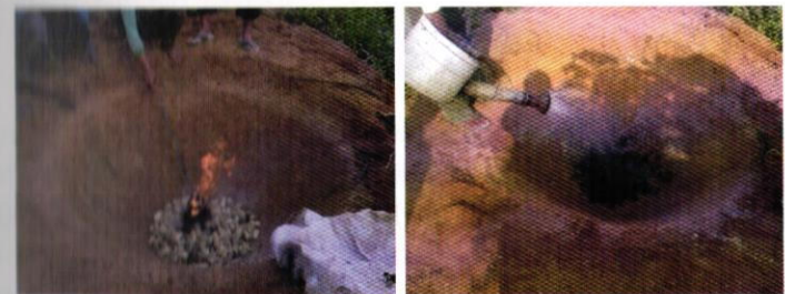
Gambar 10. Pembuatan biochar menggunakan Kontiki di KP Taman Bogo, Lampung Timur.
