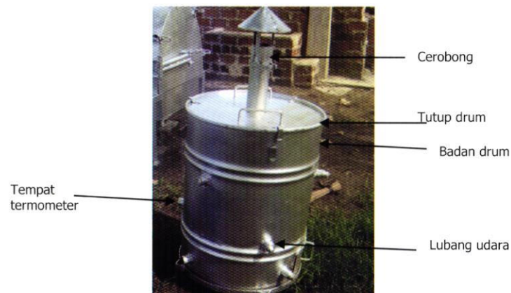
Gambar 11. Pirolisator terbuat dari drum (IPB Kiln)
