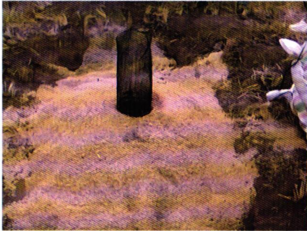
Gambar 4. Cerobong dari kawat kasa dalam pembuatan arang sekam di Bima, Nusa Tenggara Barat (Foto: Atin Kurdiana)
