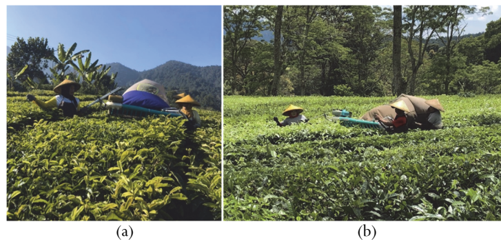
Gambar 8. Kondisi operator saat mengoperasikan mesin pada tinggi tanaman lebih dari 100 cm (a) kemiringan 5° – 10°, (b) kemiringan 35° – 40°
