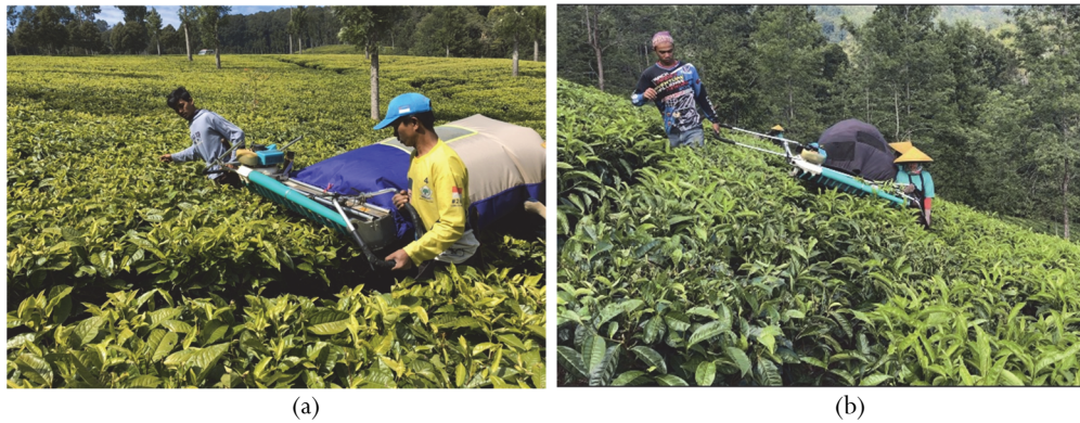
Gambar 7. Kondisi operator saat mengoperasikan mesin pada tinggi tanaman 75 cm – 80 cm (a) kemiringan 5° – 10°, (b) kemiringan 35° – 40°
