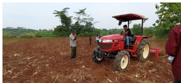
Gambar 4.4. Penggunaan rotari pada traktor roda empat
