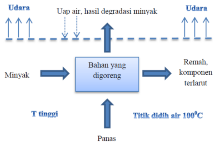
Gambar 3. Skema penggorengan deep frying pada tekanan atmosfer (Noviyanti, 2013)
