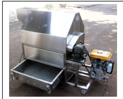
Gambar 1. Mesin sangrai kopi bahan baku arang kayu
