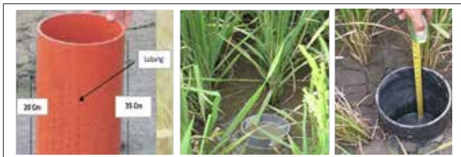
Gambar 33. Penggunaan pipa paralon untuk mengontrol ketinggian muka air tanah
