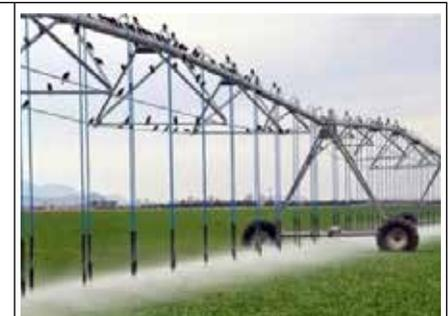
Gambar 38. Sistem irigasi pivot dinamis
