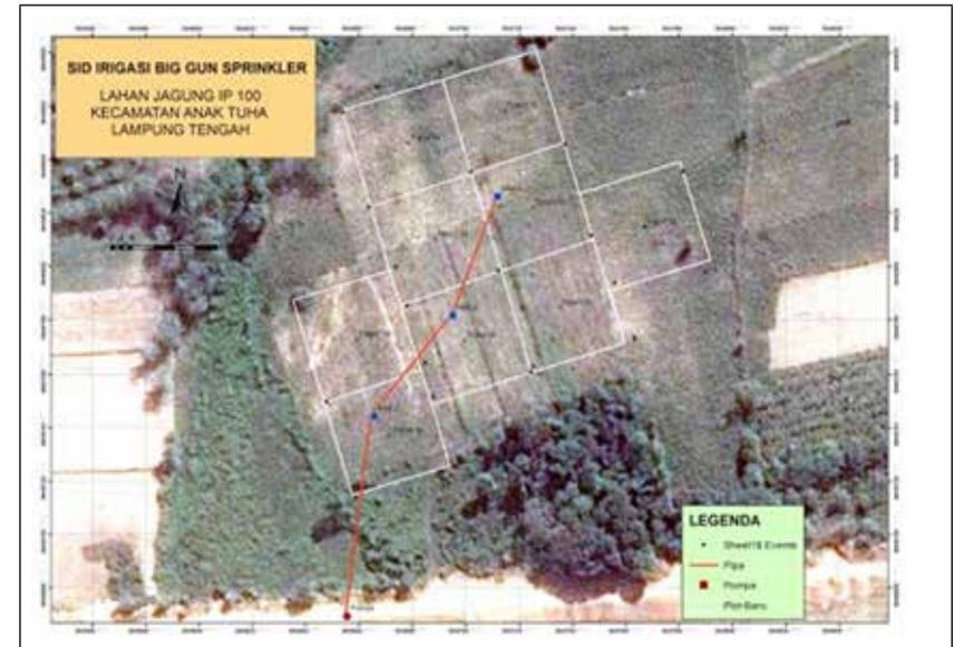
Gambar 25. Instalasi sistem irigasi *big gun sprinkler* untuk pengairan tanaman jagung seluas 1,2 ha di Desa Bumi Udik, Kecamatan Anak Tuha, Lampung Tengah
