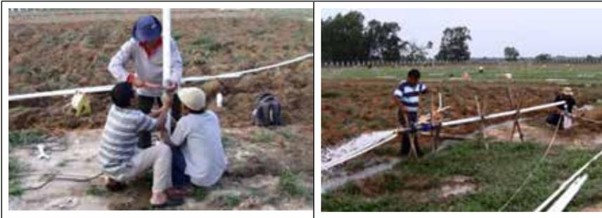
Gambar 7. Uji pemompaan sumur air tanah dalam (pumping test) di Kebun Percobaan Taman Bogor: (a) Pemasangan pompa submersible dan pipa PVC; (b) Pengamatan debit dan penurunan muka air tanah
