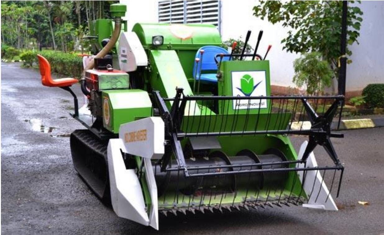
Mesin combine harvester bekerja melalui tahapan berturut-turut: memotong tegakkan batang tanaman, menyalurkan tanaman terpotong ke silinder, merontokkan gabah dari tangkai dan batang, memisahkan gabah dari jerami, dan membersihkan gabah dengan membuang gabah hampa dan benda asing.
