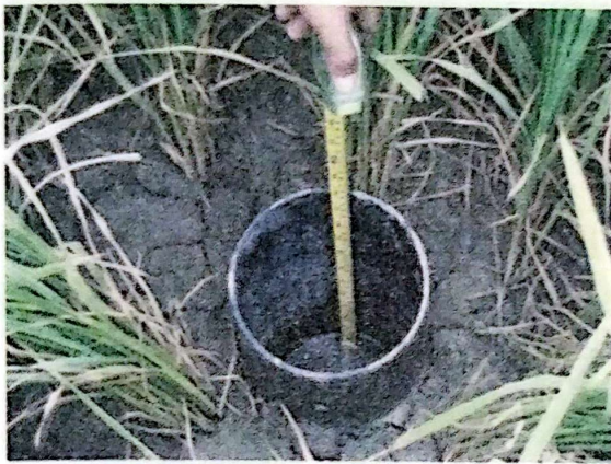
Gambar 13. Pengukuran kedalaman permukaan air dalam paralon dan kondisi sawah yang perlu diairi
