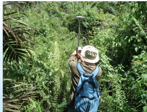
Gambar 1. Pengukuran Topografi menggunakan GPS Geodetik untuk mengetahui elevasi outlet embung secara akurat
