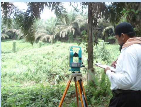
Gambar 2. Pengukuran Topografi menggunakan Theodolit untuk mengidentifikasi volume embung
