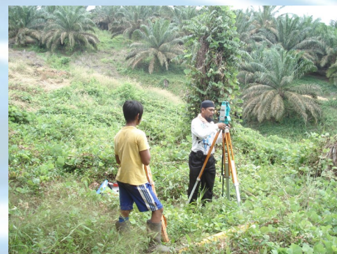
Gambar 2. Pengukuran Topografi menggunakan Theodolit untuk mengidentifikasi volume embung
