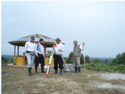
Gambar 1. Pengukuran Topografi menggunakan GPS Geodetik untuk mengetahui elevasi outlet embung secara akurat
