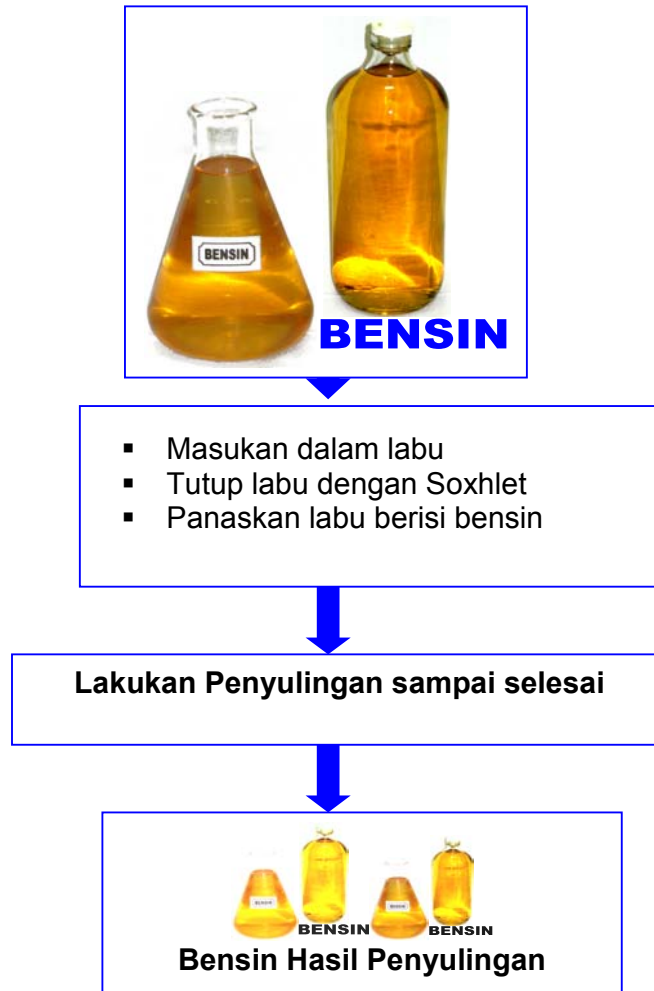
Gambar 2. Proses penyulingan bensin
