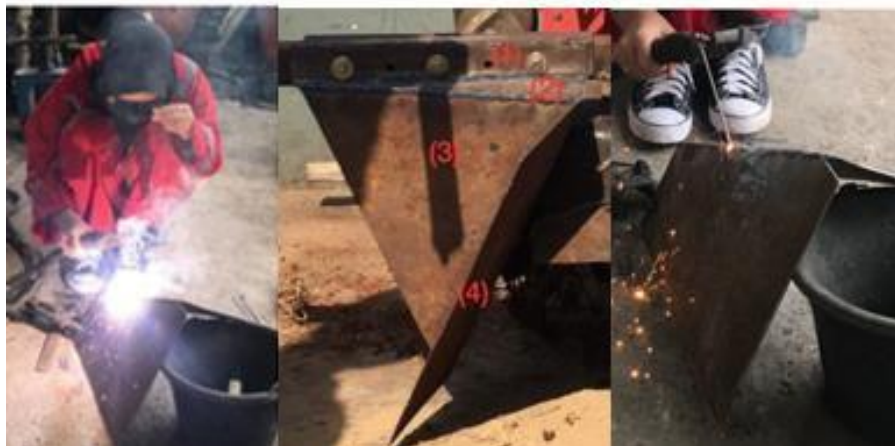
Gambar 4.11. Proses pengelasan hollow, sayap, penahan, dan pisau
