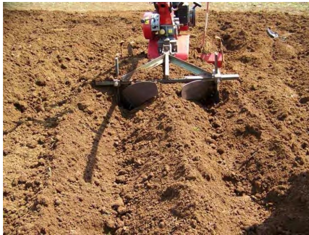
Gambar 2.3. Bajak guludan untuk membuat alur
