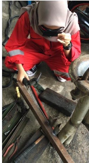
Gambar 4.10. Proses pengelasan hollow dan besi penghubung
