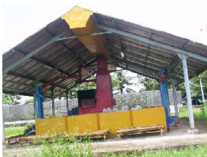
Gambar 2. Konstruksi alat mesin pengering jagung dengan sumber panas matahari dan pembakaran tongkol jagung/kayu.
