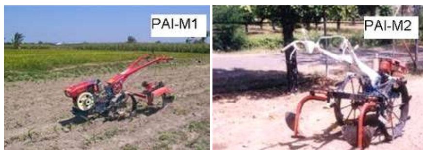
Gambar 11. Alat pembuat alur irigasi/pembumbun jagung model PAI-M1 dan PAI-M2.
