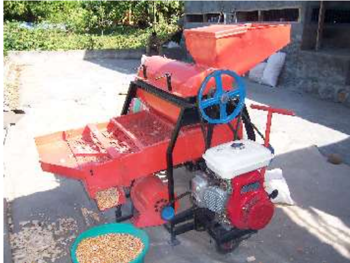
Gambar 8. Alsin pemipil jagung model PJ-M1-Balitsereal (Subandi et al. 2003).
