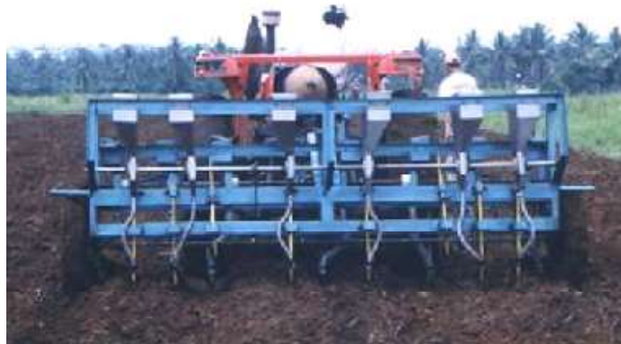
Gambar 7. Alat pemupuk dan tanam mekanis dengan tenaga penggerak traktor roda empat (prototipe 1) rekayasa BB Mektan.
