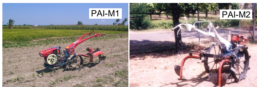
Gambar 8. Alat pembuat alur model PAI-M1 dan PAI-M2 (Aqil et al. 2004).
