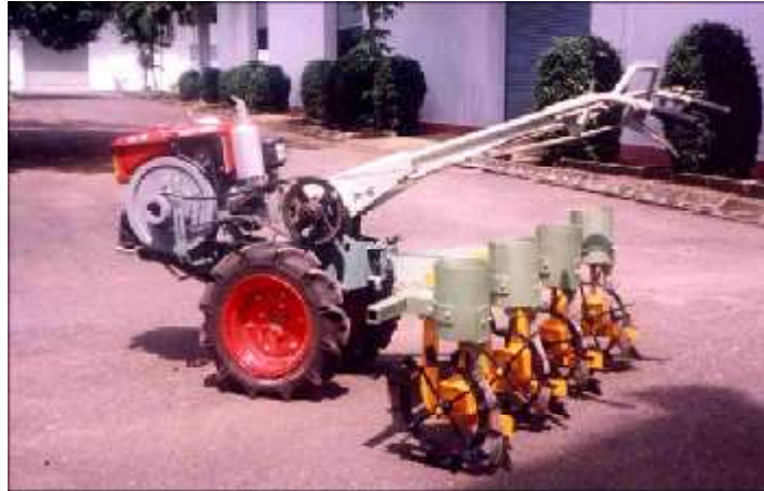
Gambar 5. Alat tanam mekanis dengan tenaga penggerak traktor tangan rekayasa BB Mektan.
