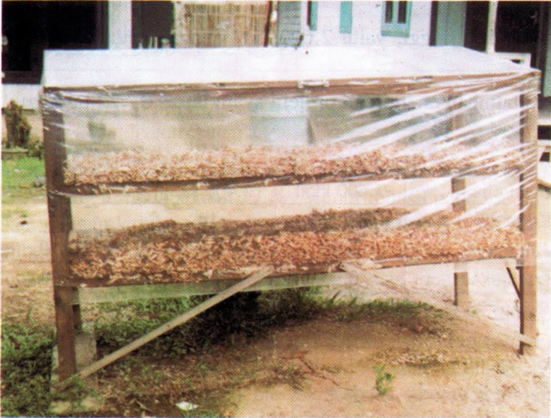
Gambar 1 : Teknologi sederhana pengeringan cangkang dan kepala udang sebagai sumber bahan baku ransum alternatif
