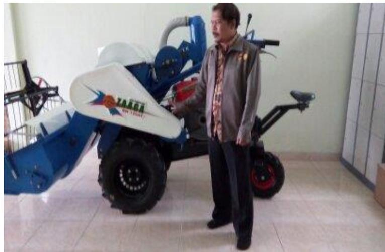
Gambar 3. Mini Combine (bantuan pemerintah), tetapi Tidak dapat Digunakan di Lapangan
