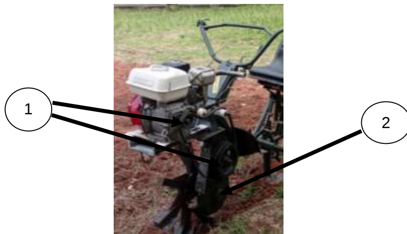
Gambar 4. 5. Sistem transmisi traktor roda satu
