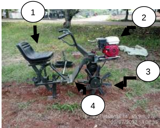
Gambar 4. 1. (a). Traktor roda satu tampak depan, (b). Traktor roda satu tampak isometric .
