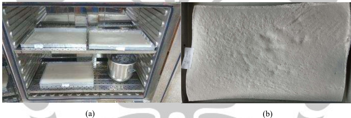
Gambar 4.3. Proses pengeringan campuran PLA/pati sagu (a), tampilan komposit setelah pengeringan (b)
