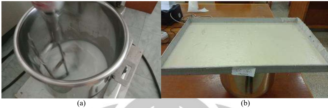
Gambar 4.2. Proses pengadukan campuran PLA/pati sagu (a) dan penuangan larutan pada cetakan (b)
