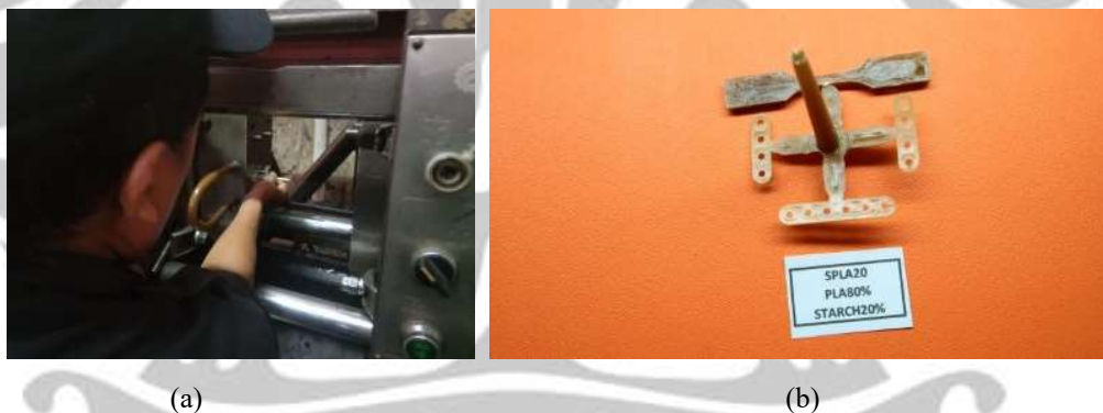
Gambar 4.5. Proses injection molding miniplate (a) dan hasil pencetakan miniplate (b)
