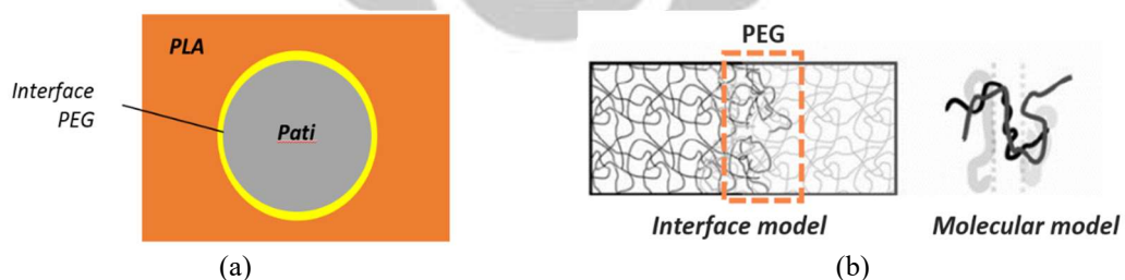
Gambar 4.30. Ilustrasi ikatan antarmuka permukaan PLA/pati sagu/PEG
