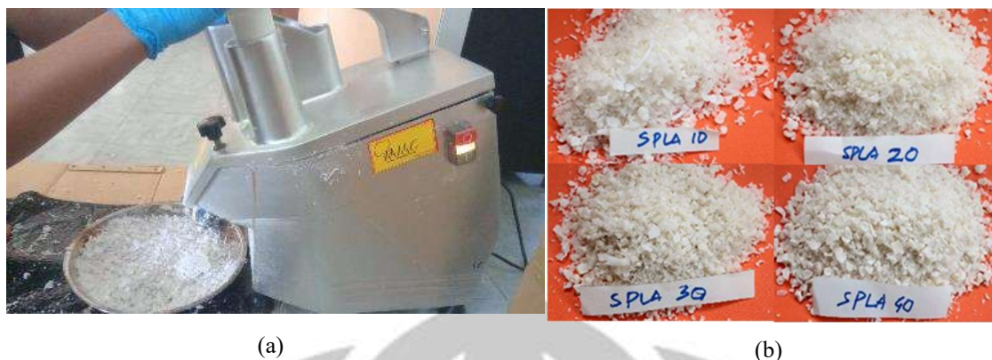
Gambar 4.4. Proses pengecilan ukuran komposit (a) dan hasil pengecilan (b)
