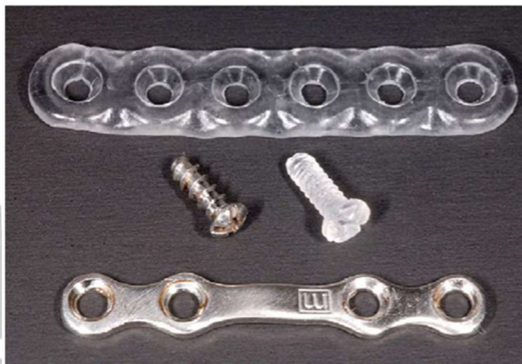
Gambar 2.7. Perbandingan bentuk dan dimensi dari pelat dan sekrup dengan material terdegradasi (atas) dan titanium (bawah)
